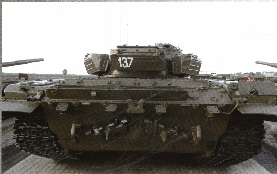
Танк Т-72А, вид сзади. Хорошо видно крепление запасных тракв.
